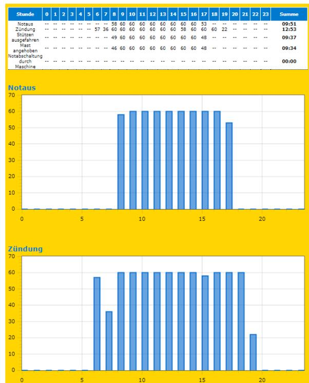
Die folgenden Diagramme zeigen den Nutzungszeitraum der Maschine an. Das obere Diagramm zeigt die Total-Werte an. Das ist die Gesamtzeit jeden Tages vom ersten Einschalten der Maschine bis zum letzten Ausschalten. Das untere Diagramm zeigt die Effektiv-Werte an. Das sind die tatsächlichen Nutzungszeiten der Maschine. Diese können erheblich von den Zeiten des ersten Diagramms abweichen. Bei Mietmaschinen sollte diese Tabelle zur Abrechnung verwendet werden.
