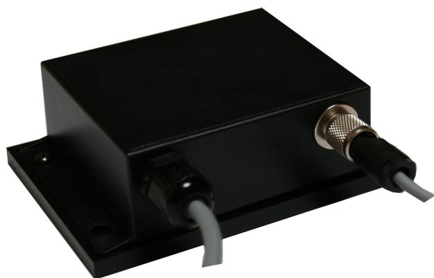
Der 5 pol. Anschlußstecker des Schlüsselmoduls wird in die Buchse am EQTrace TD-Key-Modul eingesteckt. Ist die Funktion am Obserwando Server freigeschaltet, werden Schlüssel automatisch erkannt, wenn sie zum Betreiben des Fahrzeugs berechtigt sind.
