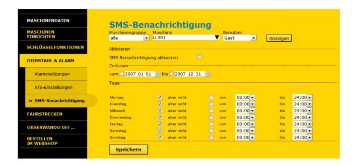
Die Alarmmeldungen werden vom Server an alle für das Gerät aktivierten Benutzer per SMS versendet. Wichtig dabei ist, dass für den jeweiligen Benutzer in den Stammdaten eine gültige Mobilfunk-Rufnummer eingetragen ist. Nach Versenden einer Alarmmeldung wird die Überwachung für das Gerät deaktiviert, um wiederholte SMS zu verhindern
